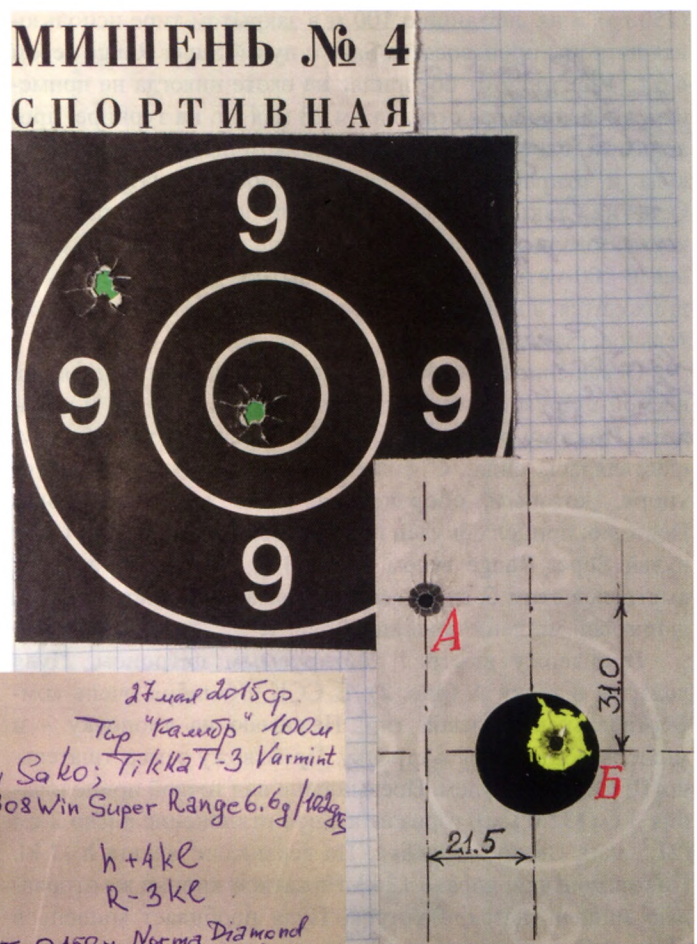
Рис. 2. Пуля SP, патрон РМР, тест 30.06.15, 100 м
